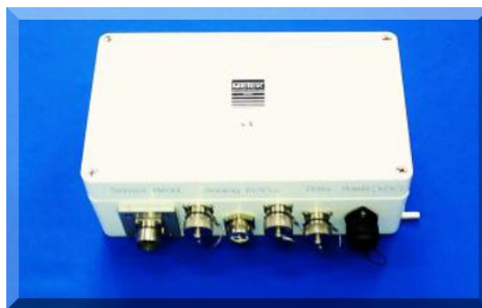
Box dell'elettronica, collegato alla testa di misura con cavo da 6 metri
